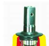
Корок захищений від викручування, повністю закритий гумовим пильовиком
